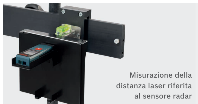
Bersaglio con spostamento trasversale: la scala di traslazione fornisce una guida precisa
