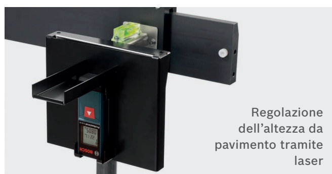
Misurazione della distanza laser riferita al sensore radar
